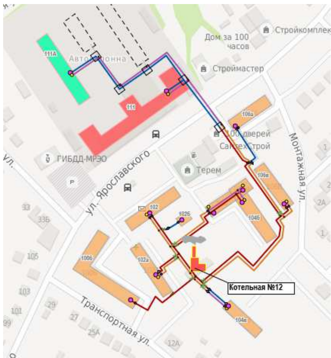
Рис. 1.27. Существующая схема тепловых сетей в зоне действия источника тепловой энергии – котельной №12
