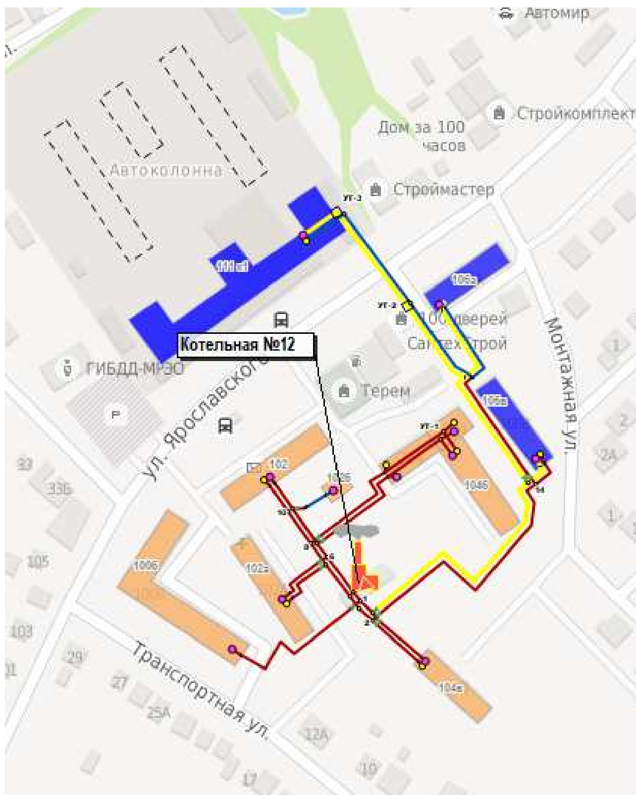
Рис. 3.33. Графическое изображение отказа элемента тепловой сети от котельной №12.
