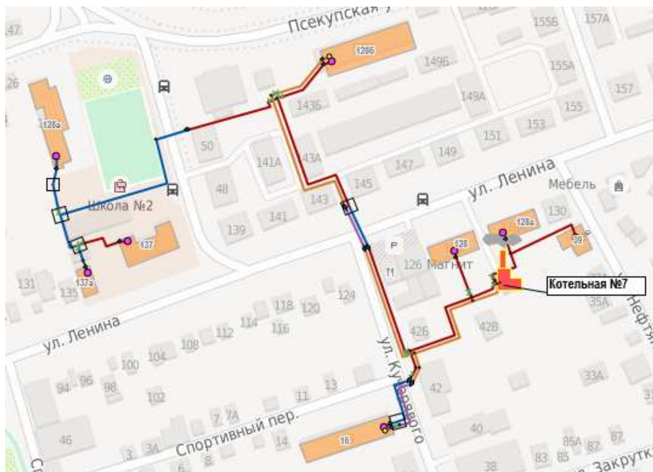
Рис. 1.24. Существующая схема тепловых сетей в зоне действия источника тепловой энергии – котельной №7
