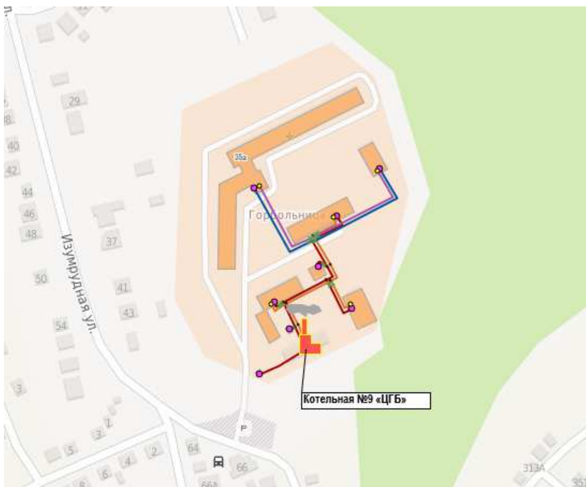
Рис. 1.25. Существующая схема тепловых сетей в зоне действия источника тепловой энергии – котельной №9 «ЦГБ»
