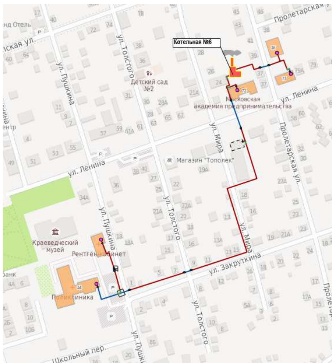
Рис. 1.22. Существующая схема тепловых сетей в зоне действия источника тепловой энергии – котельной №6 «Университет»
