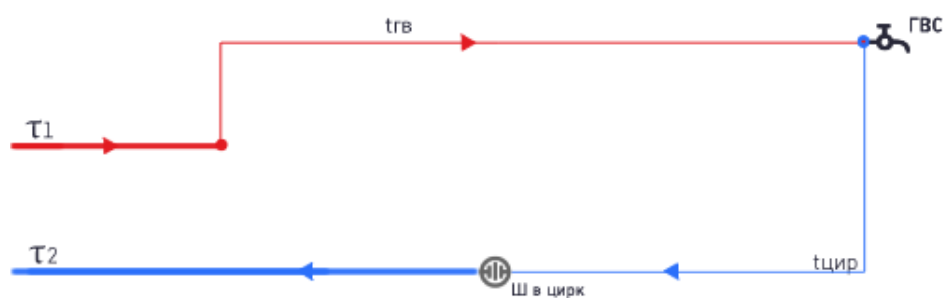
Рис. 1.37. Схема присоединения системы горячего водоснабжения потребителей по четырехтрубной схеме теплоснабжения.
