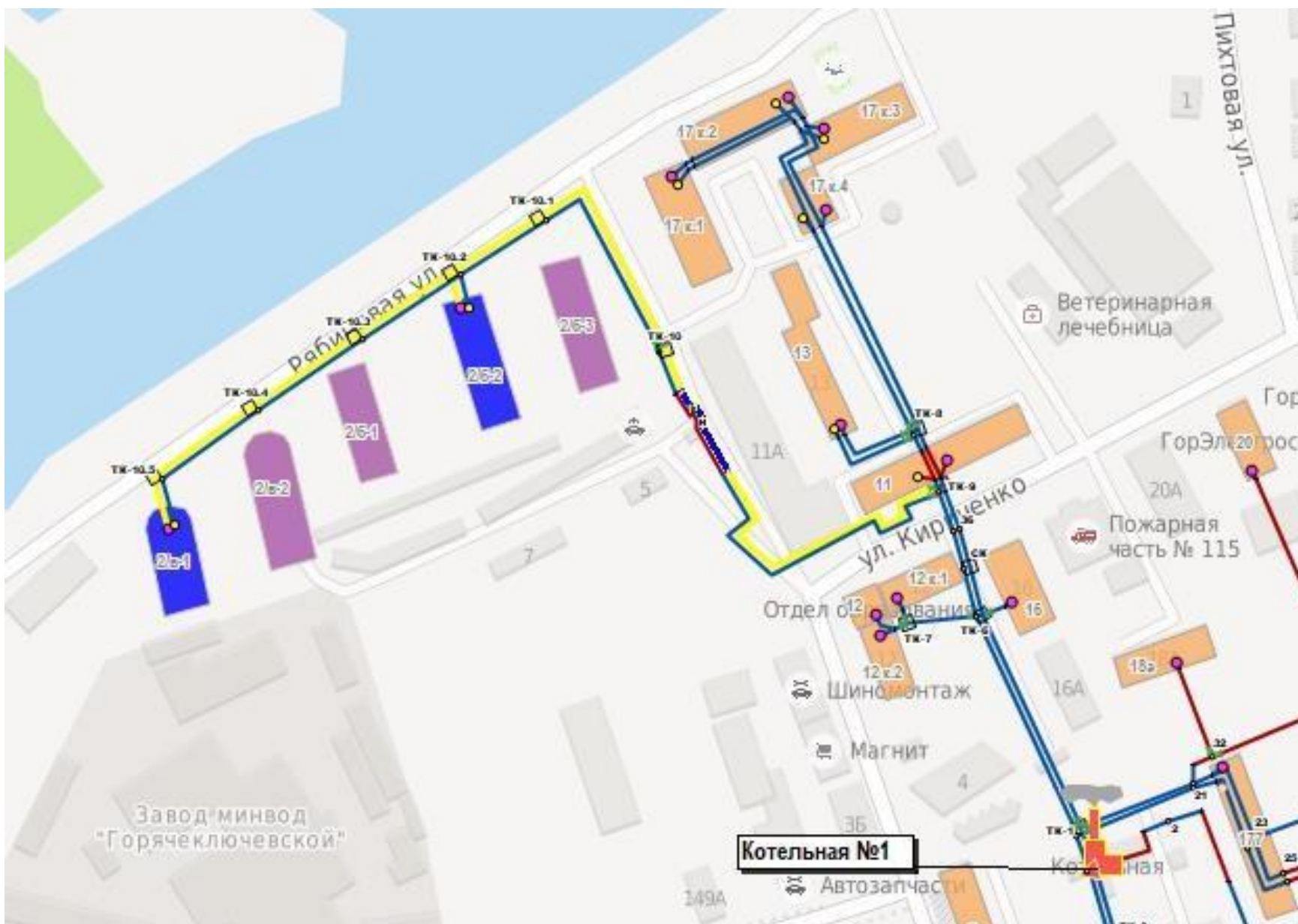
Рис. 3.25. Графическое изображение отказа элемента тепловой сети от котельной №1.
