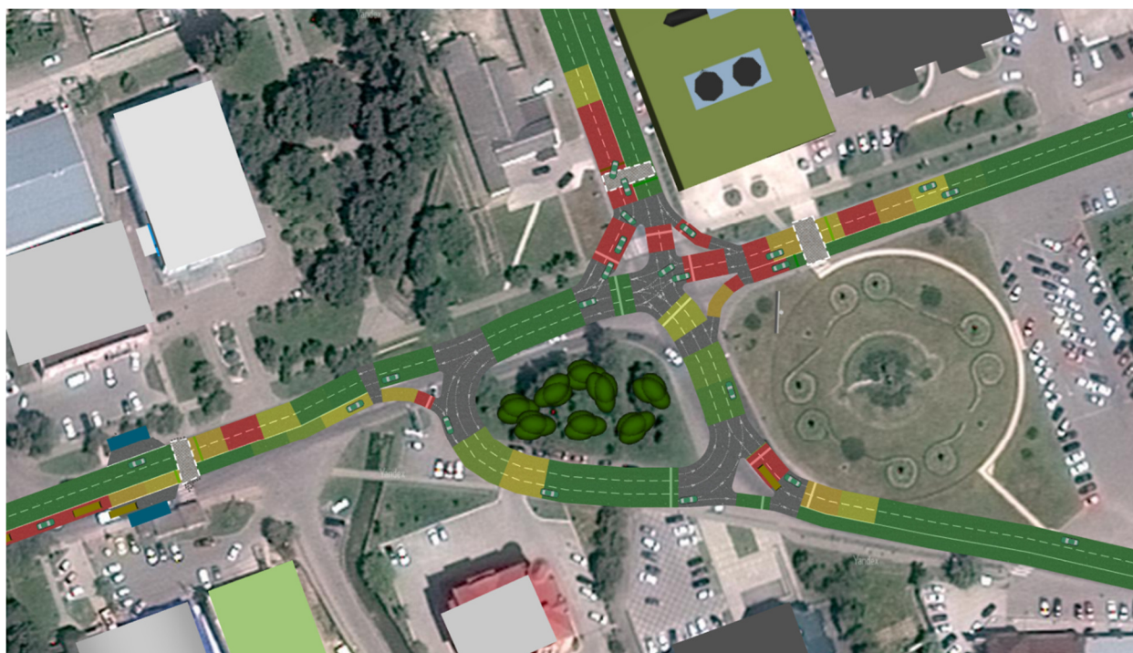
Рисунок 7.2.4.5 Перспективная картограмма скорости ТП в ключевом транспортном узле №1 в утренний пиковый период
