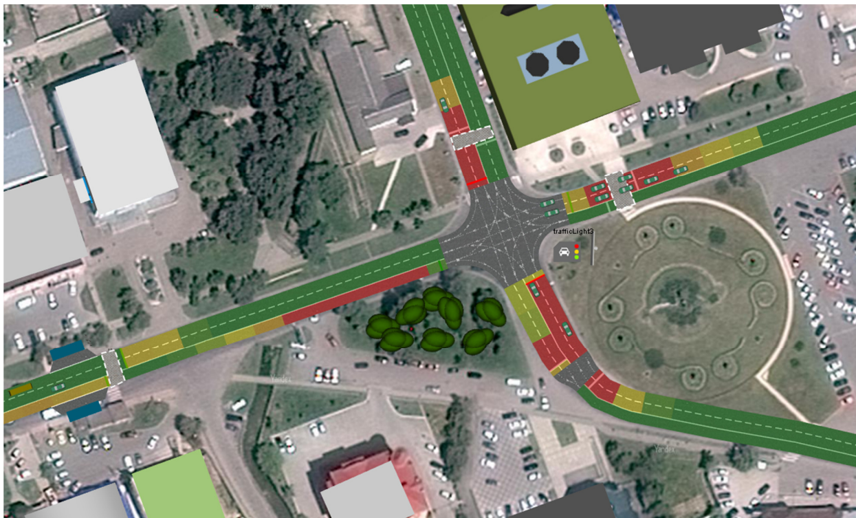
Рисунок 7.2.4.2 Существующая картограмма скорости ТП в ключевом транспортном узле №1 в утренний пиковый период
